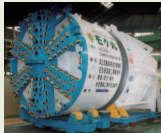
写真1—シールド機械(φ4,800mm)
