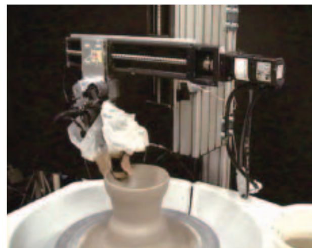
■図8—遠隔陶芸ロボットによる成形の様子
