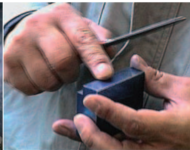
■写真2—指の腹で金属表面の仕上がりを確認し、引っ掛かりがないかを確認する
