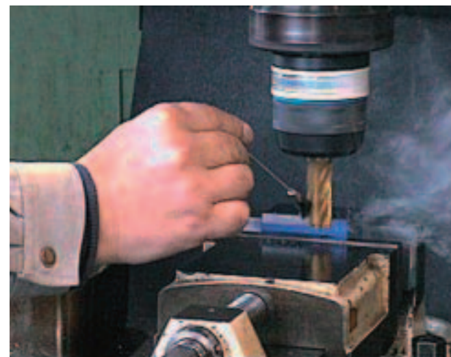
■写真1—フライス刃物に刷毛で油を付けながら回転の様子で煙の上がり具合を観察する
