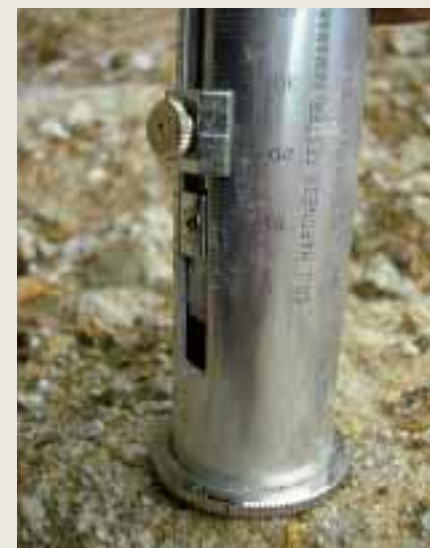
■写真1—土壌硬度計による測定
