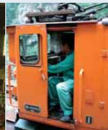
■写真2—運転台が狭いため、横向きに座って運転する
