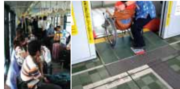
■写真3—ゆいレールの車内 ■写真4—渡し板がせり上がって段差をなくす装置、ラクーブ
