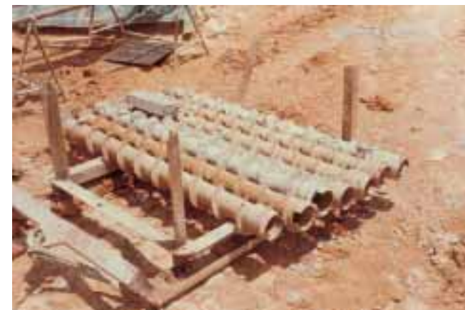
写真3 ボーリングロッド兼用のコアチューブ
