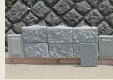
■写真13—分節効果の検証(護岸ブロック)
