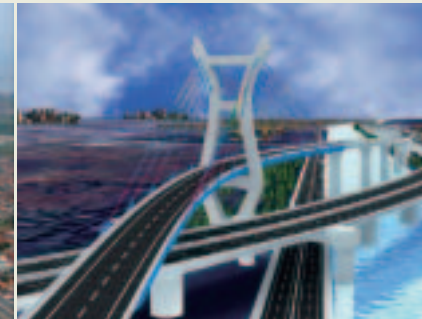
■図5—既存高架道路を跨ぐ斜張橋 (W-2 Section)
