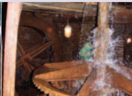
■写真6—「お気に入りの噴水」を動かす地下の水車と歯車
