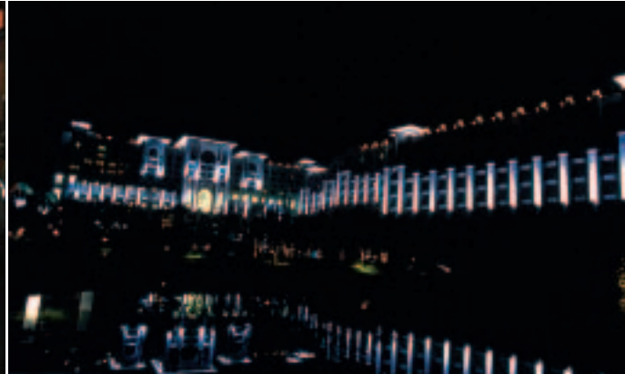
写真6 セラミックメタルハライドランプ投光器による外壁照明(ロッテホテル・チェジュ)
