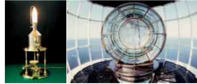
写真6（左） 石油蒸発白熱灯器 写真7（右） フレネルレンズ（光源からの光を束にしてより強い光にする）
