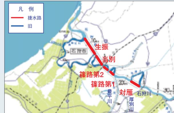
図1 石狩川第1区工事の5捷水路
