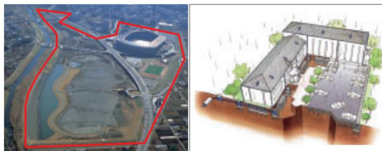
写真2 施設による適応策。遊水地の例 図5 施設による適応策。雨水浸透施設
