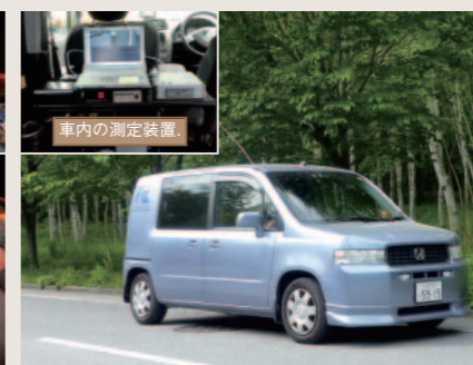
自社開発IRI: International Roughness Index (路面凹凸の指標)測定車
