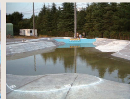
韓国栄州ダム全体水理模型実験(クレアリア筑波研究所)
