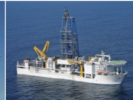
写真4 地球深部探査船「ちきゅう」。掘削された泥や岩石の屑を泥水で船の上まで押し上げるライザーと呼ばれる太いパイプと、暴噴防止装置をもつ
