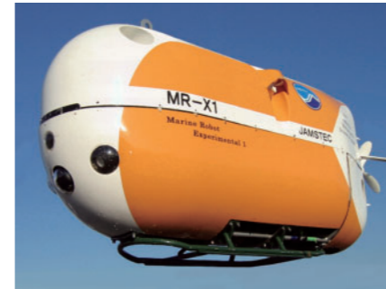
写真3 自律型の無人探査機「MR-X1」。全長2.5m、幅0.8m、高さ1.2mで重量は800kgと小型軽量であり、ハンドリングが極めてやさしい
