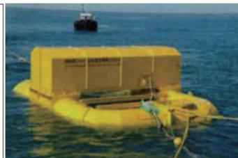
写真4 ジャイロ式波力発電の外観
