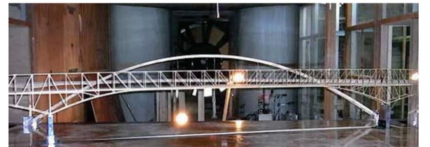
写真3 3次元風洞模型(新天門橋・天門橋並列時)
