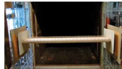
写真2 2次元風洞模型(新天門橋単独時)
