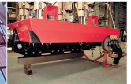
写真2 ボデーフレーム下のブレーキフィン
