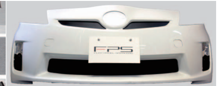
写真4 ハイブリッドスピーカーを取り付けたバンパー
