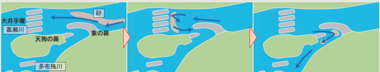
図1 砂を沈殿させる水の流れの工夫
