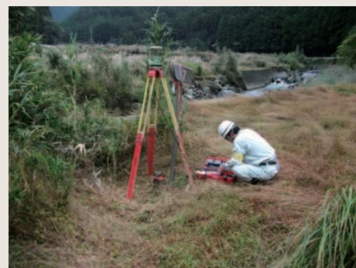
GPSでの基準点測量状況
