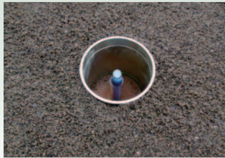
写真4 凍結深さ測定器設置
