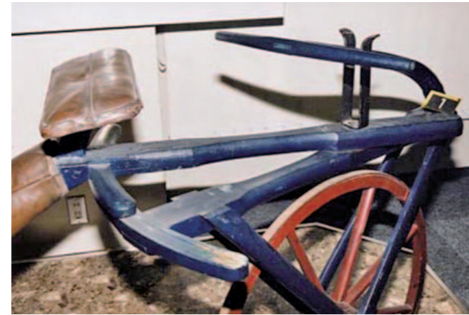
写真1 カール・ドライスが1818年に特許を取得したハンドルの仕組み
