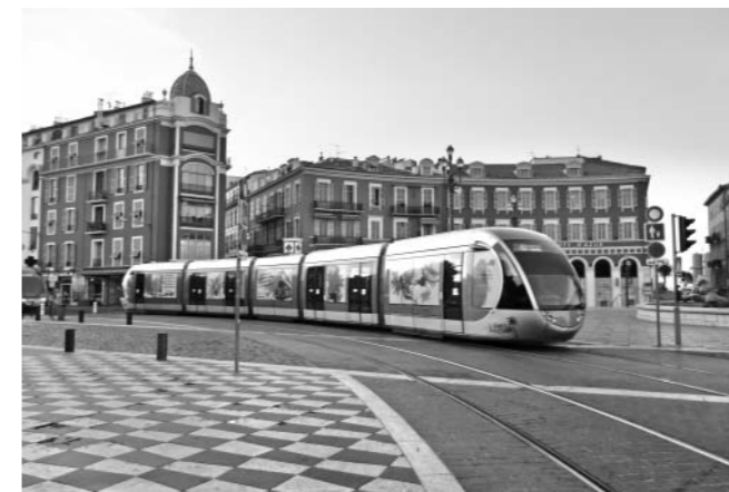
写真3 景観を重視する区間では架線からの集電ではなく電池で走行するLRT(フランス・ニース)
