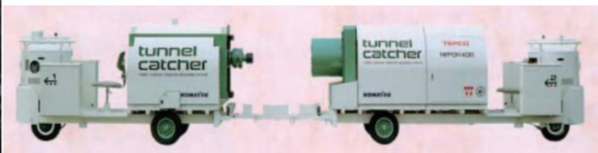
写真2 水力発電用水路トンネル計測診断システム
