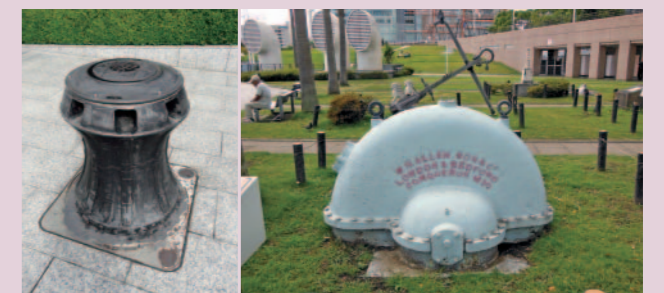
写真12(左) 「渠」の文字を中央にデザインした社章入りの係留ロープを巻き上げるキャプスタン 写真13(右) 屋外展示されているドック用排水ポンプカバー
