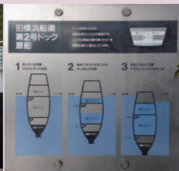
写真7 「船扉」の仕組みを図示した屋外展示パネル
