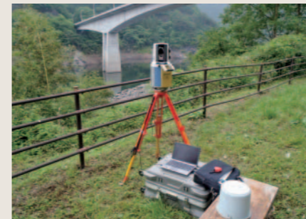
橋梁のひび割れ計測(遠隔からの計測)
