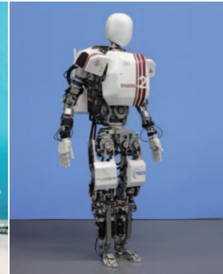
写真9 人間運動シミュレーション用2足歩行ロボットWABIAN-2
