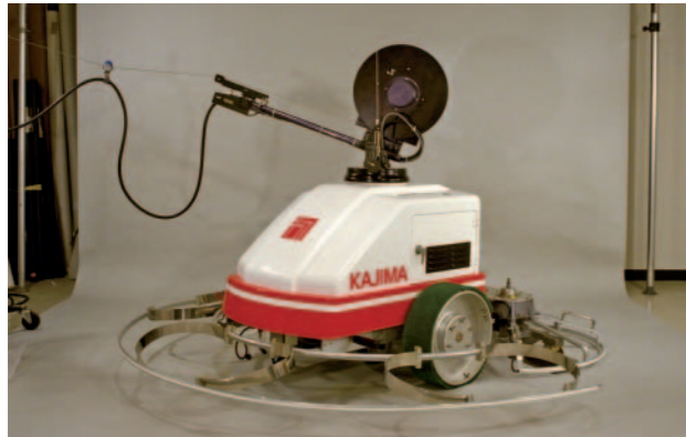
写真6 コンクリート床直仕上げロボット(写真提供:鹿島建設株式会社)
