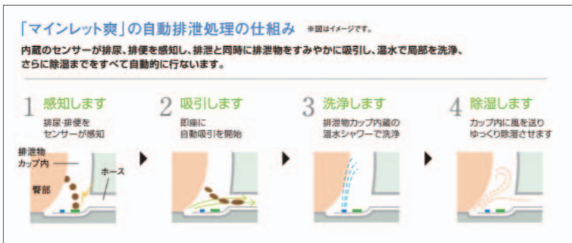
図5 「メインレット爽」の仕組み
