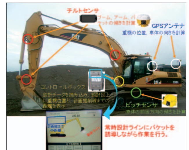
図4 油圧ショベルの誘導システム(熊谷組提供)
