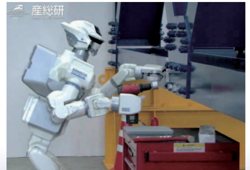
写真2 電動ドライバーでボルト締めをするHRP-3
