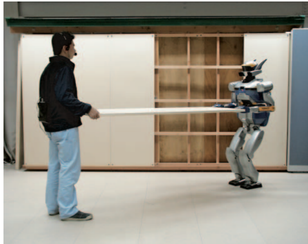
写真3 作業員とヒューマノイドロボットHRP-2によるパネルの協調搬送
