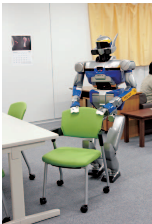
写真4 HRP-2が椅子を片付けている様子
