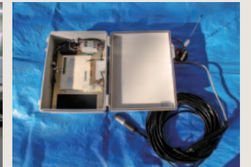
携帯電話通信を用いた監視装置
