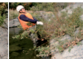
写真19 這い上がり試験
