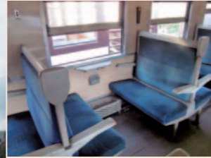
写真5 昔ながらのクロスシートの旧型客車
