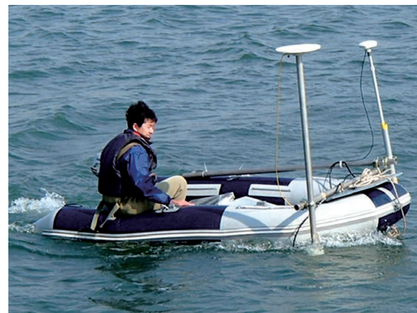
写真2 ADCPを用いた流速計測状況
