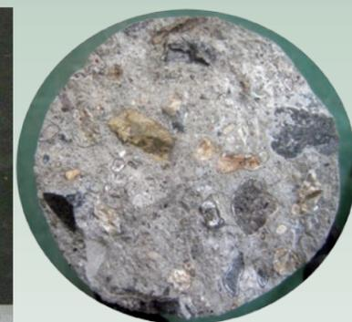
写真3 コア破断面の骨材周囲の反応リング(目視で32個)と、白色の滲出ゲル(コア番号⑩)
