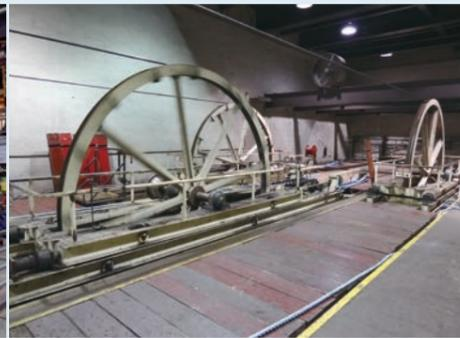
写真4 ケーブルの伸び量を調整する移動滑車
