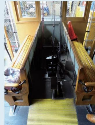
写真6 運転台のケーブルを掴む装置
