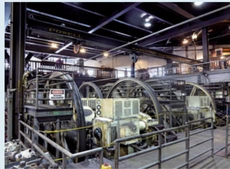
写真3 ケーブルを循環させる動力滑車
