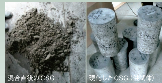
写真2 コンクリートがれきを用いたCSG
