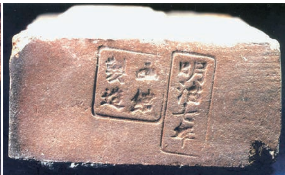
写真2 函館郊外で製造された開拓使直営工場の刻印入り赤煉瓦
