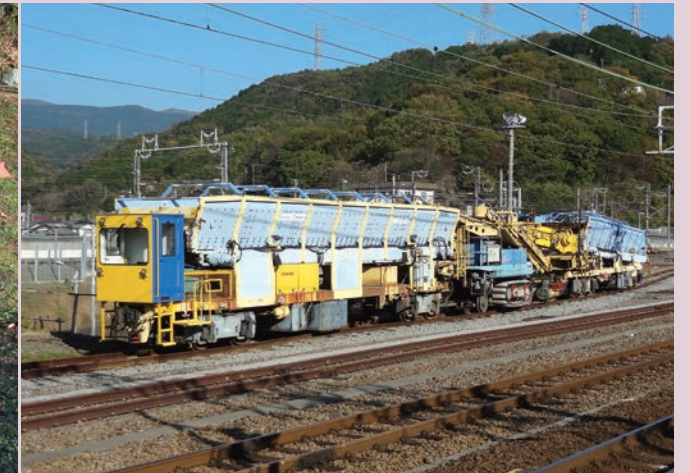
写真7 ホッパー車（前後）と道床交換機（中央）
