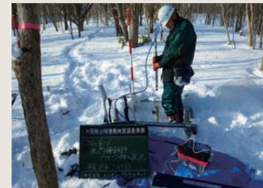
孔内傾斜計による地すべり滑動観測
