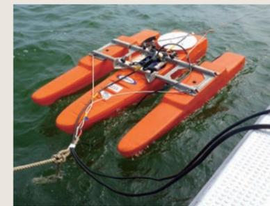
湖流調査 (超音波ドップラー多層流向流速計)
