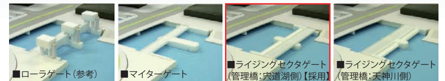
図3 模型によるゲート形式比較
