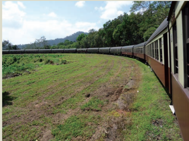
写真3 曲線半径100mの「ホースシューベンド」
