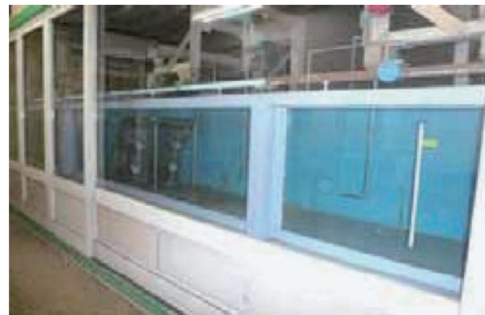
写真1 2次元造波水路（ジャケット式）
