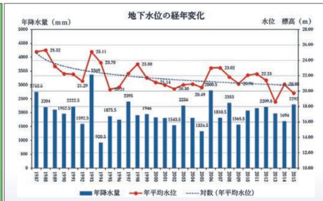
図2 地下水水位の経年変化
