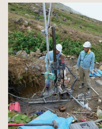
自社開発の小型ボーリング機（軽量可搬型、山岳・狭険地）
