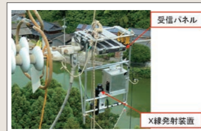
X線による電線劣化判定（関西電力との共同）
