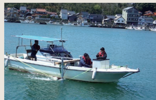
ナローマルチビームによる測深 (海底3D計測)
